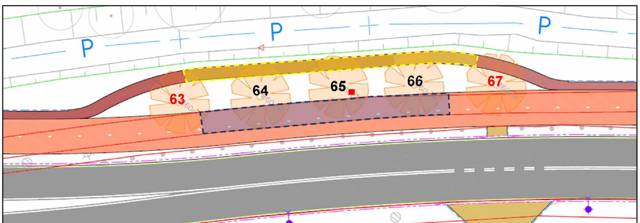
Figuur 13: Aanpassing binnen het aanleggen van het fietspad (blauw) en het voetpad (geel) nabij boomnummers 64, 65 en 66. Niet te handhaven boomnummers in rood.
