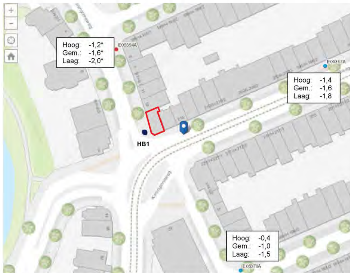
Afbeelding 2-1: Waternet peilbuizen in de omgeving van de projectlocatie met de hoge, gemiddelde en lage grondwaterstand [NAP m]. De projectlocatie is aangegeven met rood.
