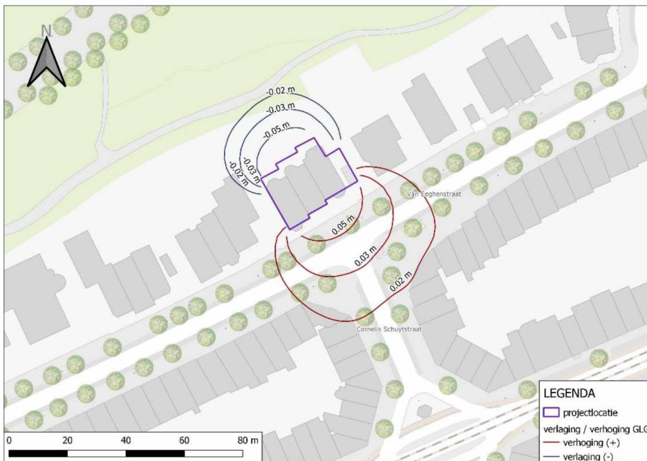
Figuur 9 Verandering van de grondwaterstanden in het freatisch pakket bij een GLG scenario
