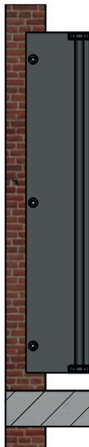
Drs. D-D Verlengde muurstrip t.b.v. afdichting ruimte tussen gevel en hekwerk
