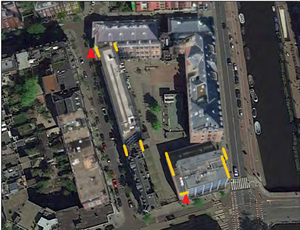
Figuur 5: de gevels met geschikte openingen en open stootvoegen (geel gemarkeerd). De gevels met de vleermuiskasten zijn aangegeven met de rode driehoeken.
