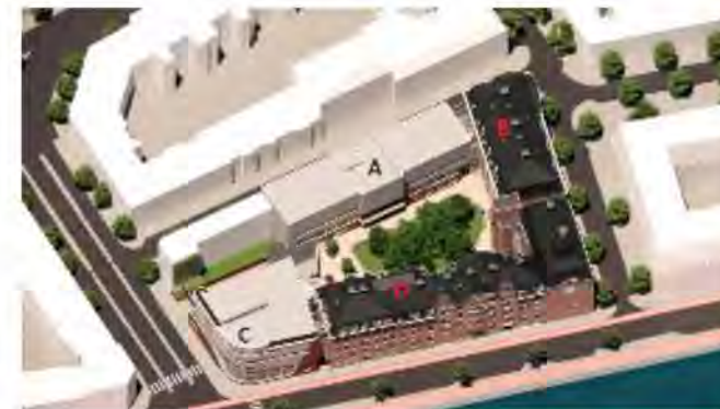
Figuur 2.4: Het vernieuwde MLA waarbij de bouwdelen A en C zijn vervangen en de hof een tuin is geworden.
