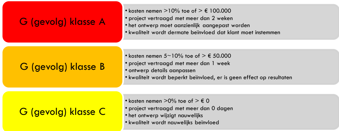
Figuur 10 –klasse A tot en met C, de gevolgen zijn rechts van de klasse beschreven in het grijze vlak. Het kan zijn dat een of meerdere gevolgen van toepassing zijn.
