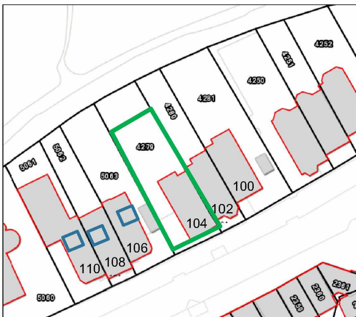
Figuur 4.1: Kavel- en gebouwgrenzen (bron: Kadaster). Groen: toekomstige kelder op de projectlocatie en blauw: bestaande kelders onder buurpanden.
