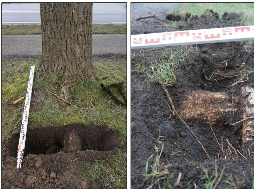
Foto 3 links: Impressie oppervlakkige beworteling boomnummer 79 in gebied C. Foto 4 rechts: Impressie beworteling in bestaand fietspad bij boomnummer 74 in gebied D.
