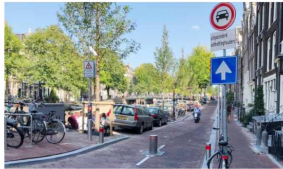
Verzinkbare paal (Vezip) Bedienen met Nexs-pas Gaat automatisch na passeren weer omhoog
