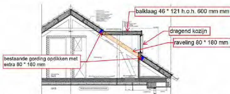
Figuur 4: aanvullende maatregelen t.b.v. dakramen en dakkapellen
