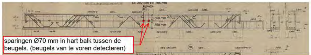
Figuur 18: eisen aan het doorboren van de funderingsbalk
