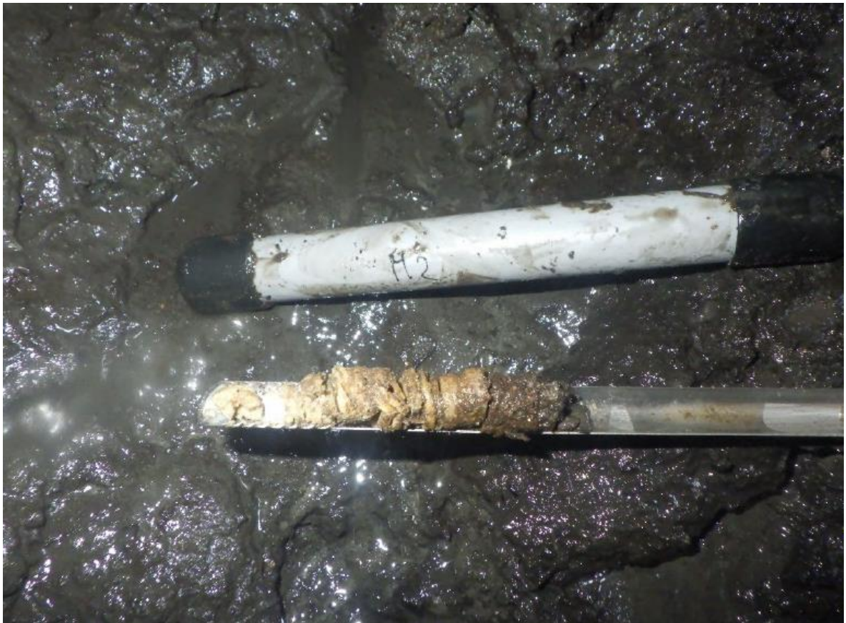
Houtmonster is zacht en niet geschikt voor het laboratorium (Houtmonster paal 2)
