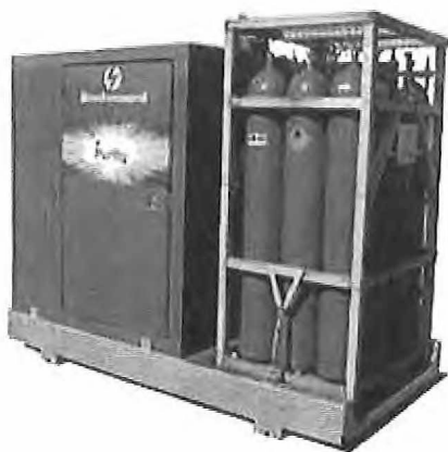
Figuur 9 Zorg bij gebruik van een aggregaat met zuurstof voeding voor een opstelling van de gasflessen met voldoende afscherming van het publiek. Volg bij plaatsing de instructies van de fabrikant/leverancier op.
