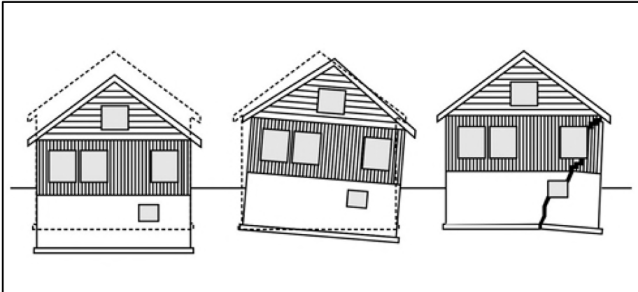
Typen zakkings van gebouwen (gelijkmatig, scheefstand, lokaal)
