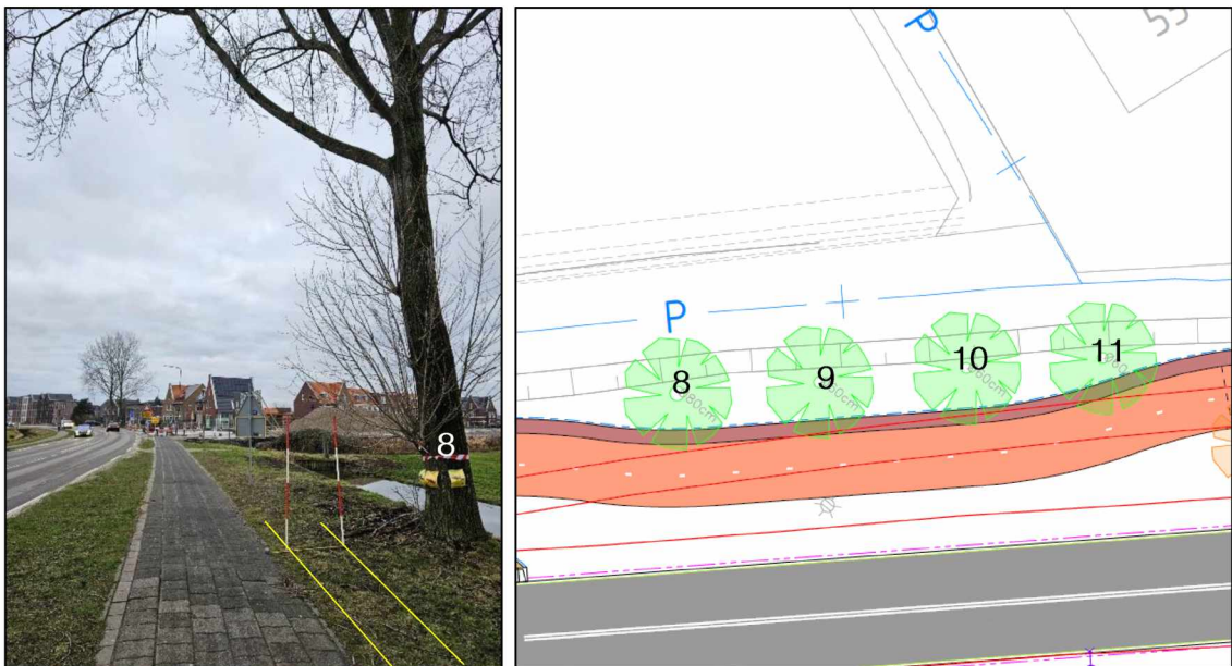
Foto 1 links: Impressie van de locatie van het te realiseren voetpad (gele lijnen) nabij boom 8. Figuur 1 rechts: Uitsnede van het ontwerp met boomnummers.
