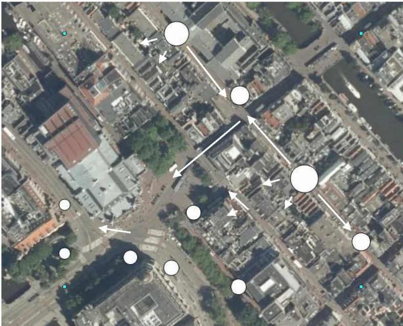
Figuur 4 - peilbuislocaties (omvang cirkel is de hoogte van de grondwaterstand, een grotere cirkel staat voor een hogere grondwaterstand). De peilen betreffen de ingeschatte stromingsrichting tussen de bollen, de lengte van de peil staat voor de hoeveelheid grondwater.
