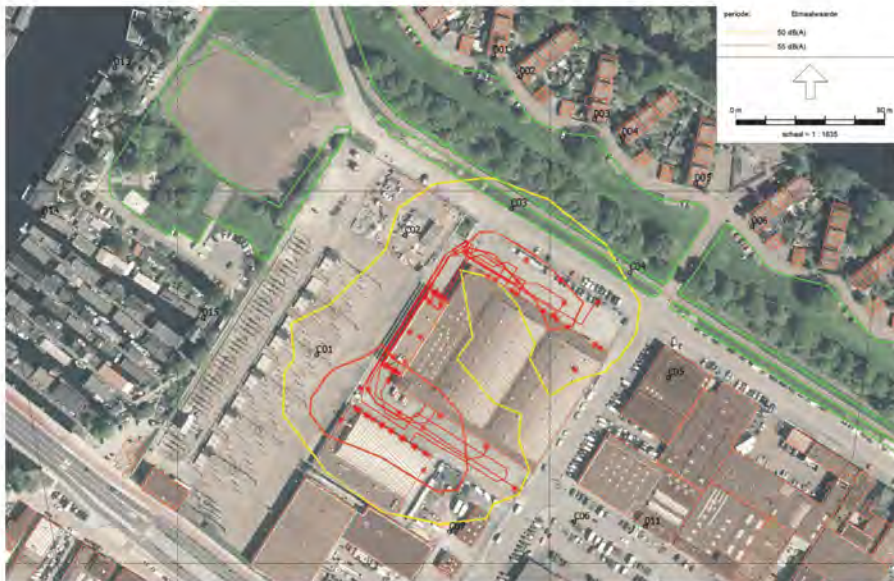
Contouren GVB busremise bij elektrificering met enkele maatregelen, geel = 50dB (A), rood = 55dB (A)
