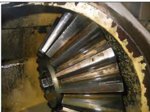
Detailfoto 10: Schade tandwiel uitgaande as HTK 1
