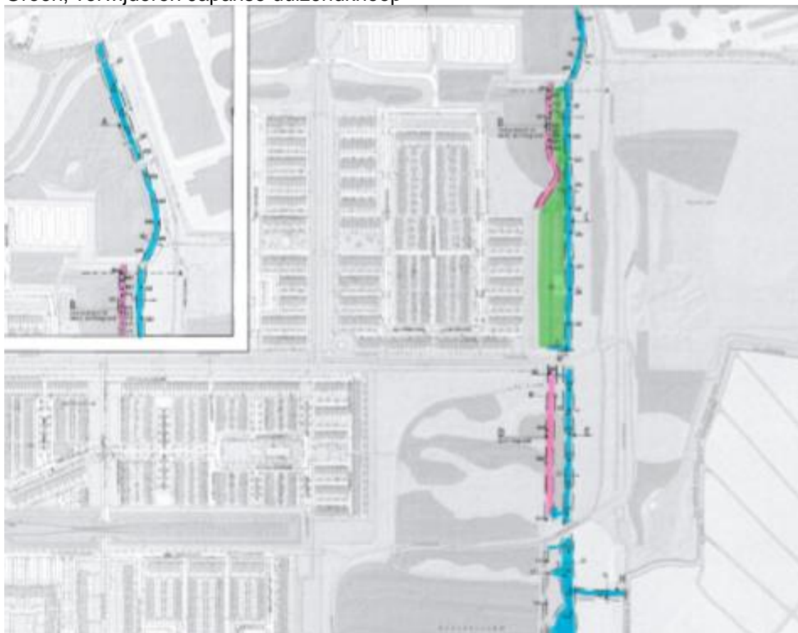
Figuur 3, graafwerkzaamheden Rose, open te graven sloten Groen, verwijderen Japanse duizendknoop
