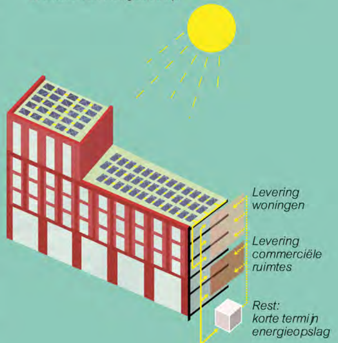
Schematische weergave uitwisseling van elektriciteit in Spring!
