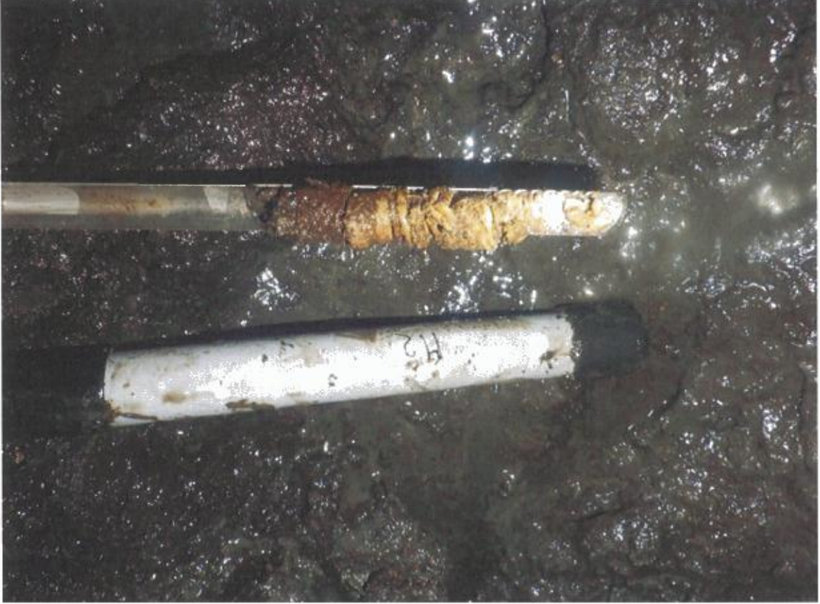
langshout 1, kesp 2 en paal 2 (kesp 2 is 50% samengedrukt)
