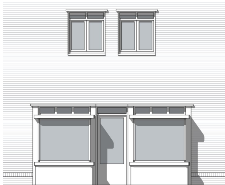
Nieuwe winkelpui, indeling en materialen conform origineel
