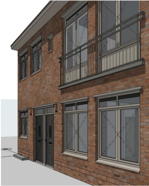
Originele negge diepte
