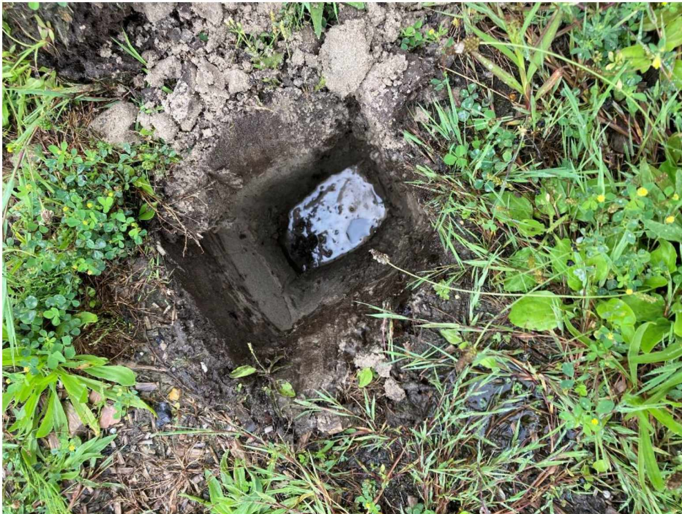
PROFIELKUIL C: 10 CM GRONDERIGE TOPLAAG / TOT - 40 CM MAAIVELD ZAND HARDE LAAG OP 40- CM - MV / KUIL VULT ZICH MET WATER VANUIT GRONDERIGE LAAG
