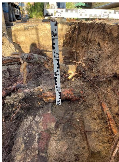
Onderste stabiliteitswortel \varnothing 10 cm is van naburige iep voor woonboot.
