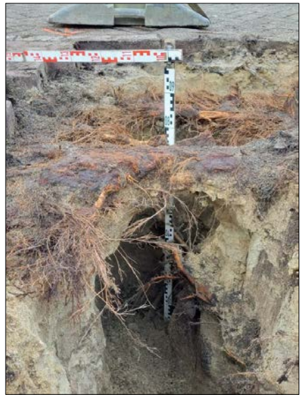
Zeer dikke gestelwortels richting rijbaan, deels afgekapt en hergroeit met dunnere wortels, verder beperkte beworteling
