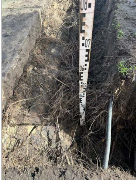
Haarwortels met uitkragende kade achterzijde boom 30
