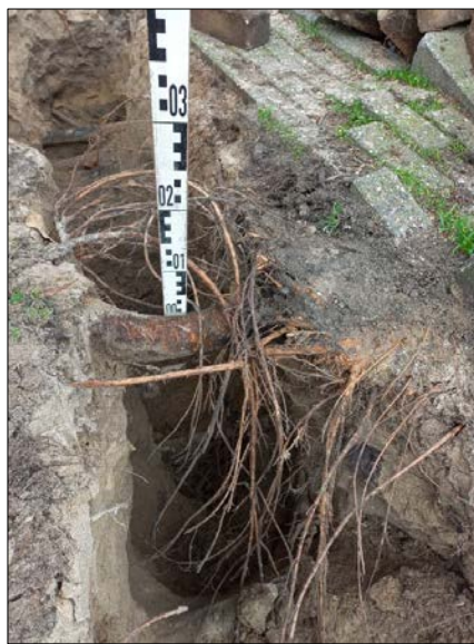
Oppervlakkige gestelwortel met opdruk in straatwerk
