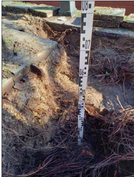
Parallel langs kade diverse gestelwortels, met oppervlakkig pakket haarwortels
