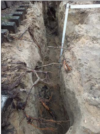
Haaks op kade (westkant boom) beperkt haarbeworteling met tegen de kade enkele gestelwortels
