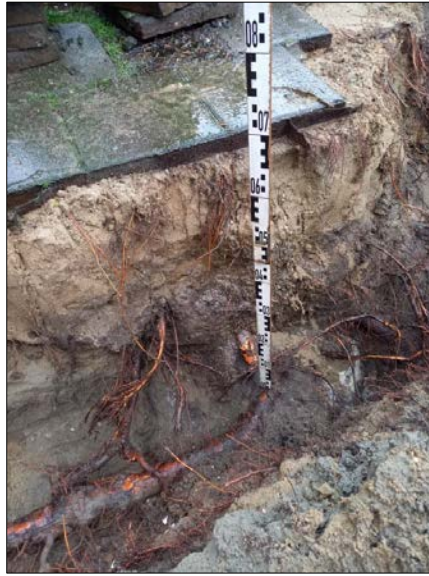
Dikke gestelwortels haaks op kade (noordzijde boom)
