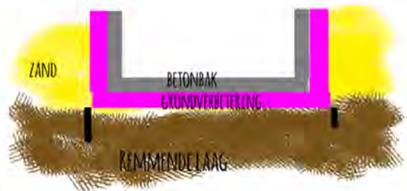
Figuur 7 – principe (paars is maatregel), verticale zwarte strepen is een voorbeeld waarbij restant damwand (beneden onderkant barrière) niet verwijderd wordt
