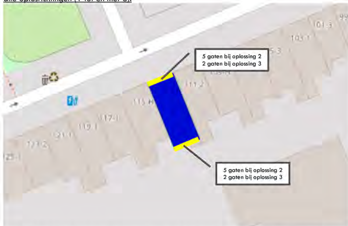
Figuur 12 – kelder is grondwaterneutraal bij toepassen maatregelen langs gevels welke geel zijn (voor alle oplosrichtingen).
