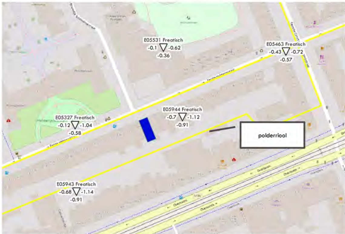
Figuur 6 – grondwaterstanden ten opzichte van NAP [m] (boven driehoek=peilbuis naam, onder driehoek=gemiddelde grondwaterstand, links driehoek=maatgevend hoge grondwaterstand, rechts driehoek=maatgevende lage grondwaterstand)
