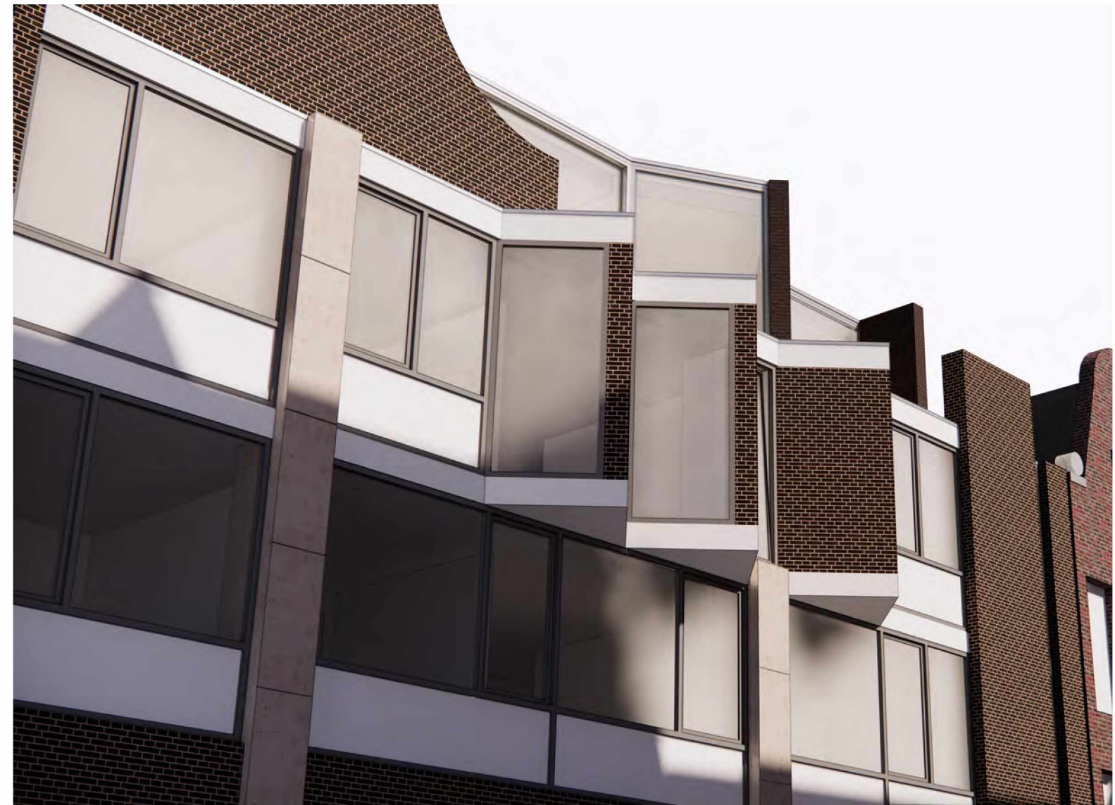
Voorstel nieuwe situatie: terug naar ontworpen detaillering en materialisering: uitzonderingen: raam links van bestaande erker wordt verdeeld + witte rand iets hoger.
