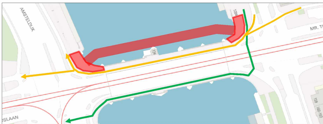
Figuur 24: Fase 2D Berlagebrug, werkterrein en verkeersbewegingen langzaam verkeer tijdens aanleg hulpbrug
