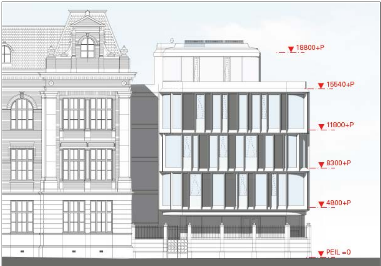
Afbeelding: de bouwhoogte van het nieuwe bouwvolume wordt exclusief opbouw lager dan de goothoogte van het gebouw van de voormalige Handelsschool en inclusief opbouw lager dan de nokhoogte van het gebouw van de voormalige Handelsschool
