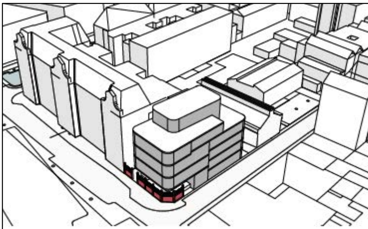
Afbeelding: de monumentale tuinmuur blijft behouden en de eerste bouwlaag van de nieuwbouw komt terug te liggen
