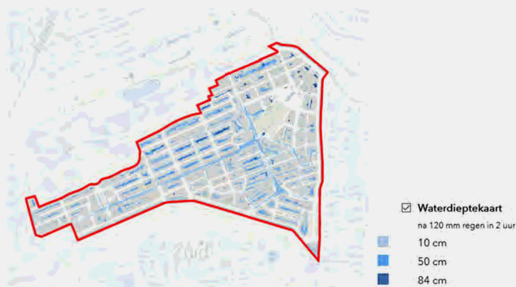
Afbeelding: Wateroverlast in de binnentuinen bij een extreme regenbui van 120 mm in 2 uur tijd in het plangebied.
