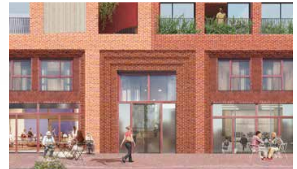
entree woningen met getrappt metselwerk
