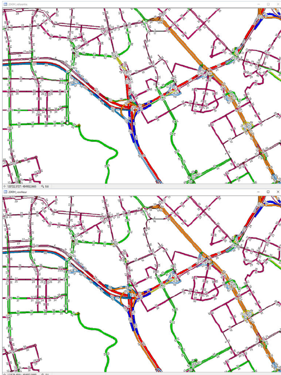
Figuur 4.6: Rijksnelheden in de avondspits voor de Referentie (boven) en de Voorkeursvariant (onder)
