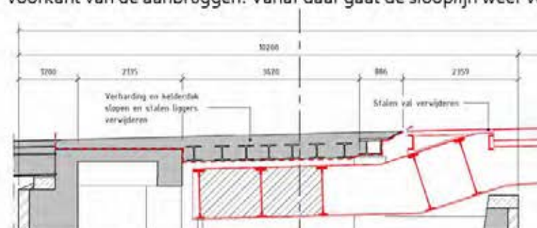
Figuur 7. Slooplijn kelderdek
