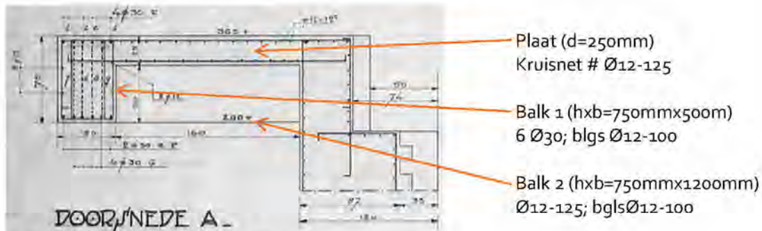
Figuur 5. Doorsnede dak boven achtergalerij
