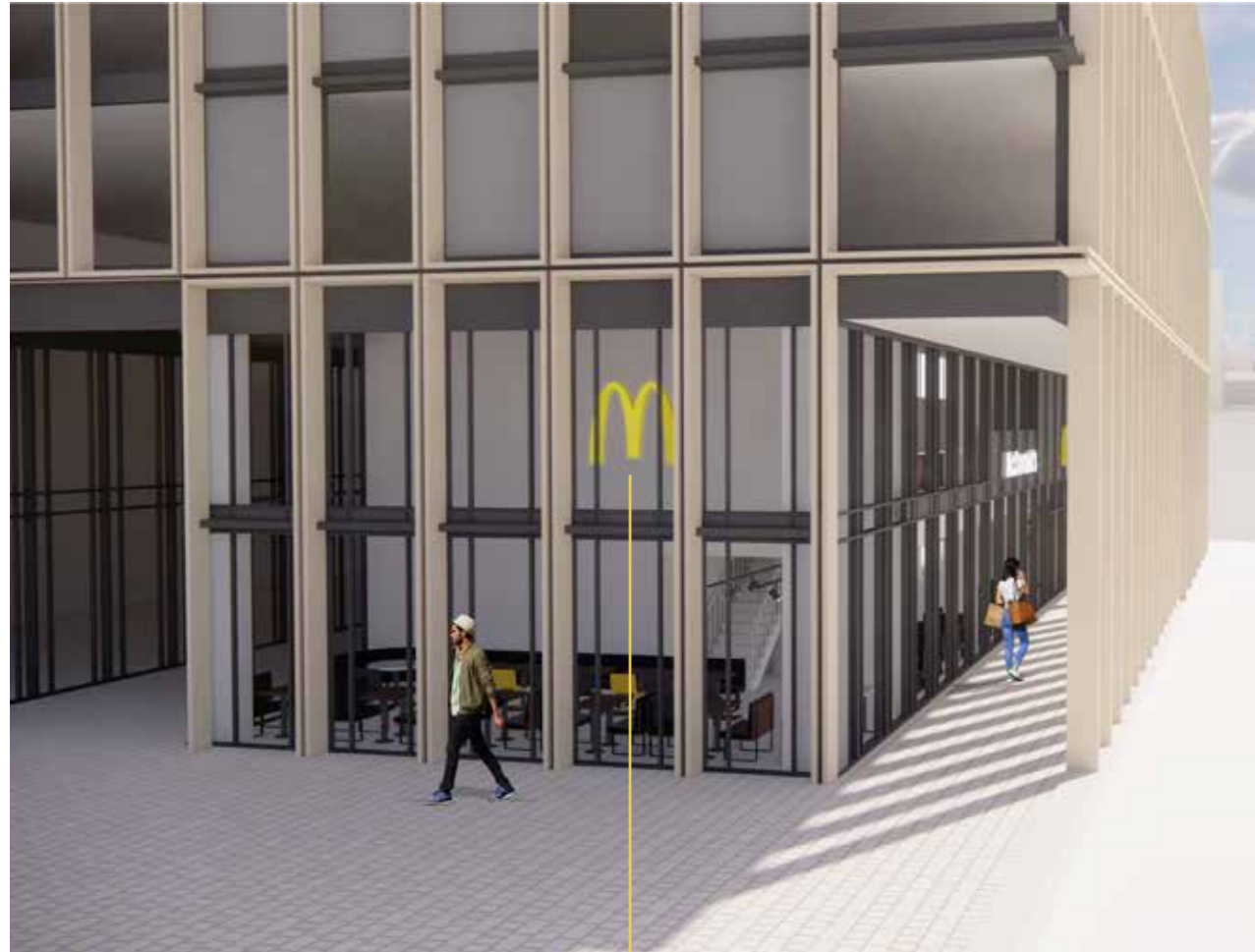
verlichte signage (ca 75mm achter het kozijn) "Golden Arch" afm. 1371x1200x120mm in kleur: Geel; RAL 1023
