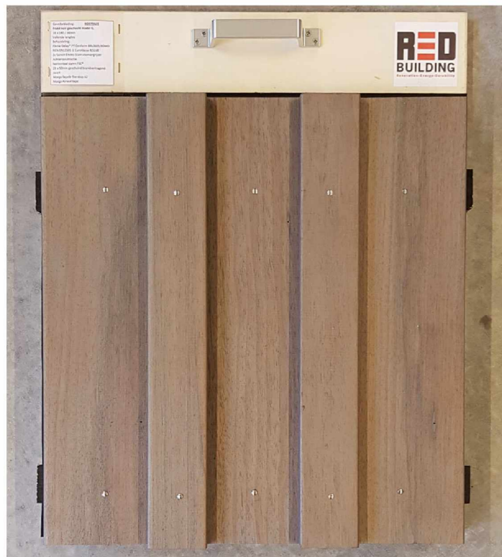
GEVEL: Naturhout fraké Opdekwerk gemodificeerd, voorvergrijsd en brandvertragend behandeld
